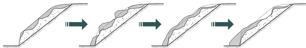
图9 火后泥石流初期的坡面泥石流演化模式
