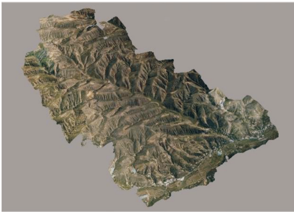
图 3 利用倾斜摄影技术生成的蛇家沟小流域实景三维模型
