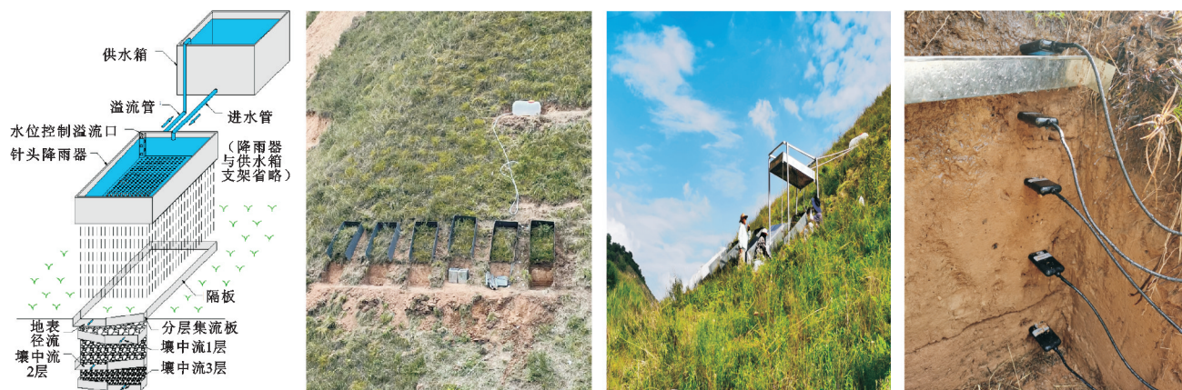
图 2 坡面人工模拟降雨径流试验示意
