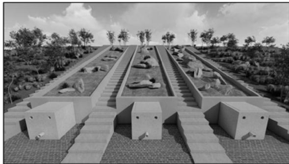
图 3 人工模拟石漠化小区示意
