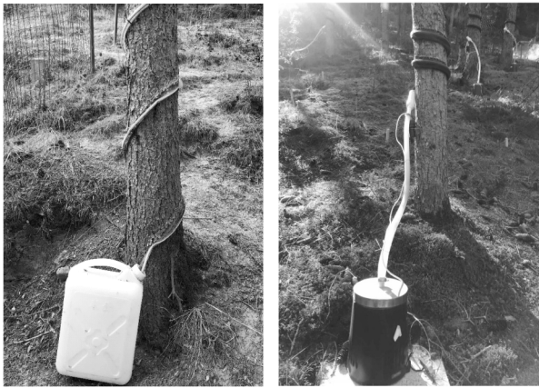
图 1 人工与自记雨量筒树干茎流采集装置比较 树干茎流量计算公式为:
