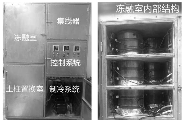
图 1 水分迁移测试系统
